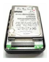
Step 3:最後にカバーをして先程外したねじをとめます。組立後ハードディスクの初期化を行ってください。
