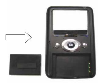
Step 3:最後にカバーをして先程外したねじをとめます。
